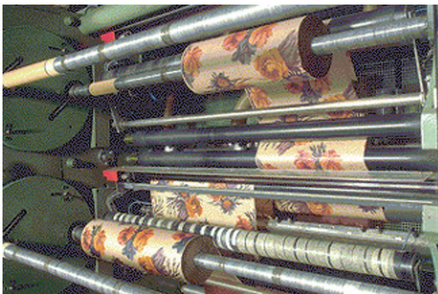
Fig. 4.7 Op deze machine wordt het papier op de gewenste breedte gesneden en opgerold
